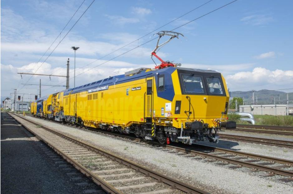
Im elektrischen Modus der hybriden E3-Antriebstechnologie ist ein vollkommen abgasfreier Betrieb möglich (Bild: Plasser).
