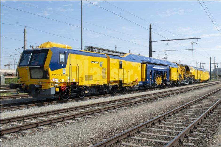
Der »Unimat 09-8x4/4S BR Dynamic E3« ist eine Kombination aus Weichen- und Streckenstopfmaschine mit Planierkapazität und dynamischem Gleisstabilisator (Bild: Plasser & Theurer).
