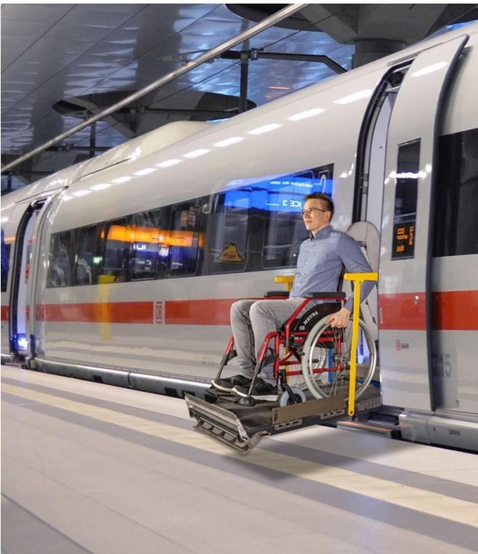
Berührt die Plattform des Lifts den Boden, legt sich die Abrollsicherung an der Front automatisch ab (Bild: Palfinger).
