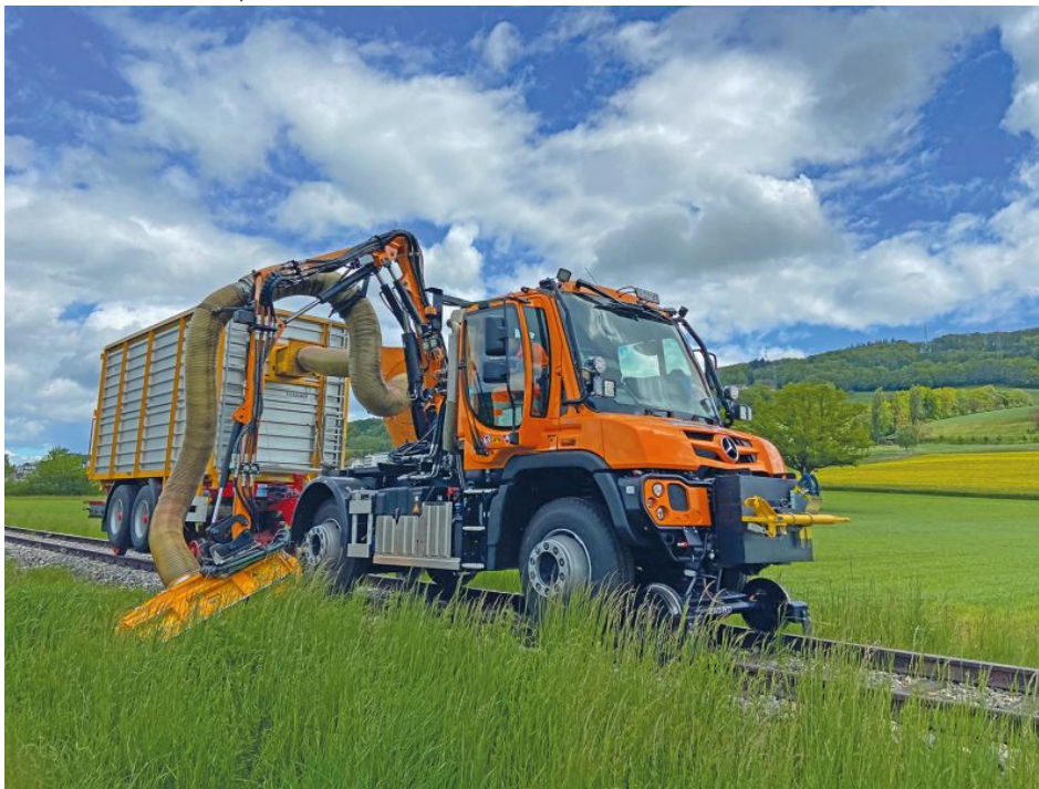
Unimog »U430« Rangierfahrzeug mit Mähanhänger von Mulag (Bild: Zagro).
