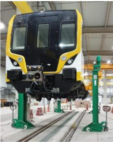
Pfaff Verkehrstechnik hat einen Großauftrag für das neue Depot der Metro Lima erfolgreich abgeschlossen, u. a. mit mobilen Hebeböcken zum Anheben einzelner entkoppelter Wagons (Bild: ColumbusMcKinnon).
