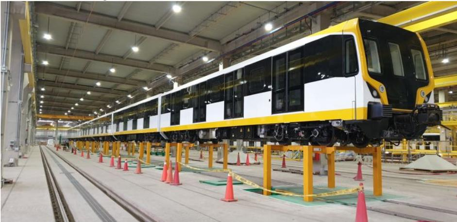
Unterflurhubanlage (UFHA) für schwere Züge mit bis zu sieben Wagen und einer Länge von 120 m (Bild: ColumbusMcKinnon).
