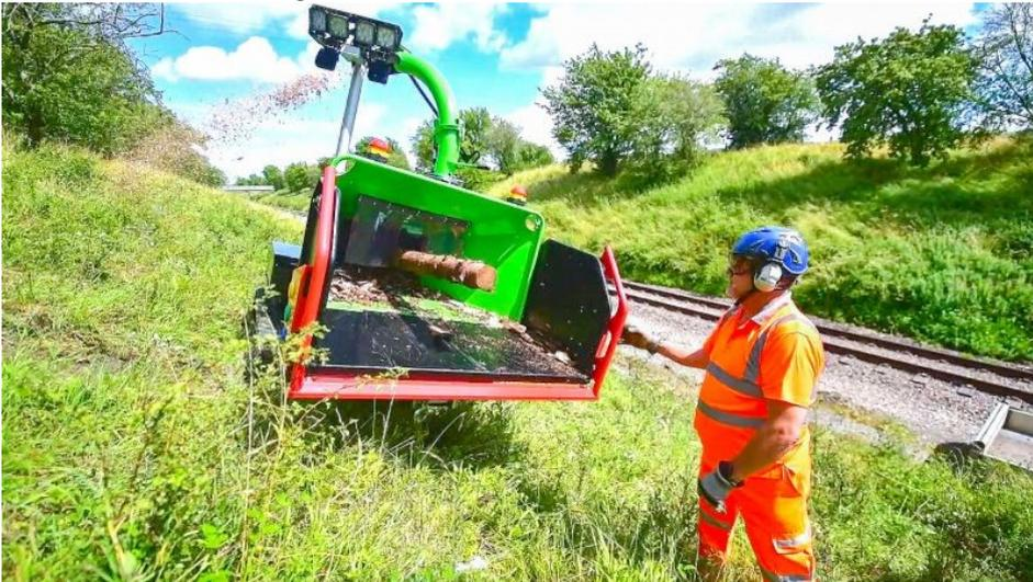
Der Raupenhäcksler »EVO 205 D SURE-Trak« meistert mit individuell schwenkbaren Ketten nahezu jedes Gelände (Bild: GreenMech).
