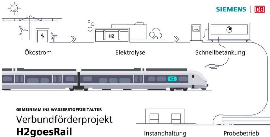
Ein Schlüsselement, um Wasserstofftechnologie im Betriebsalltag konkurrenzfähig zum bisher verwendeten Dieselmotorkraftstoff zu machen, ist ein schneller Betankungsvorgang. Die DB hat daher ein neuartiges Verfahren entwickelt, mit dem die Betankung eines Wasserstoffzuges erstmalig genauso schnell verläuft, wie die Betankung eines Dieselmotorzuges. Das ist ein wichtiger Aspekt angesichts der eng getakteten Zugfolgen im Regionalverkehr der DB.
