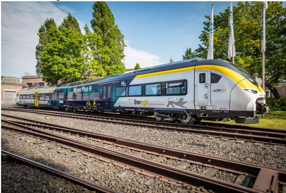
Erster Roll-out des »Mireo Plus H« Wasserstoffzuges von Siemens Mobility und des Wasserstoff-Speichertrailers für mobile Wasserstoff-Schnellbetankung der Deutschen Bahn im Mai 2022 (Bild: Siemens).
