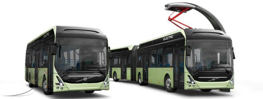
Volvo setzt beim Aufladen der Batterien auf größtmögliche Flexibilität und ermöglicht Ihnen Ladevorgänge, die sowohl über den Stromabnehmer (Pantograf) als auch über eine Kabelverbindung erfolgen können (Bilder: Volvo).
