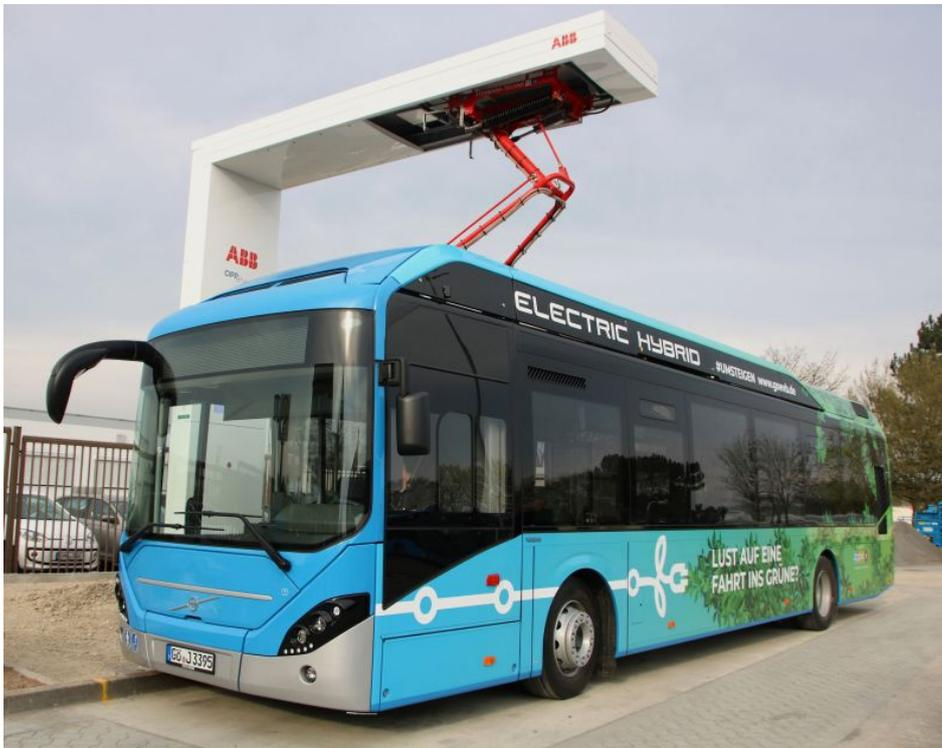
Volvo »7900 S-Charge Electric«, Hybridsolobus mit Schnellladeeinrichtung (Bild: Reinhard Fritsch).
