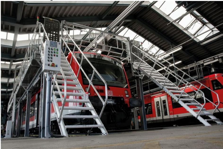
Ein Dacharbeitsstand mit beidseitigem Treppenzugang integriert in eine Wartungshalle (Bild: Krause-Werk).
