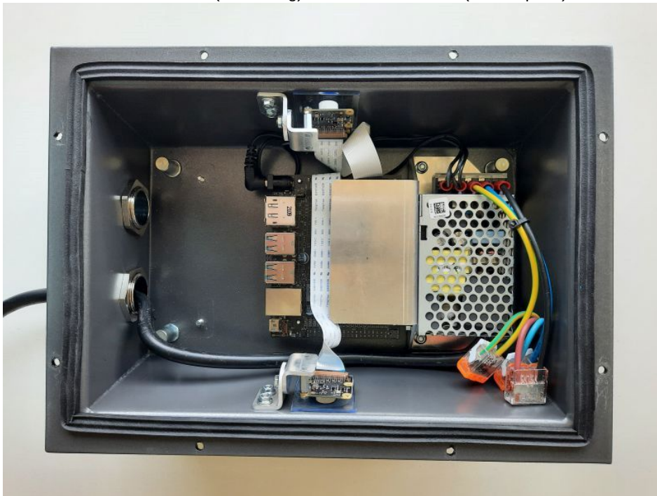
Blick in ein Gehäuse mit Sensormoduls als Standalone-Lösung (Bild: Funkwerk).
