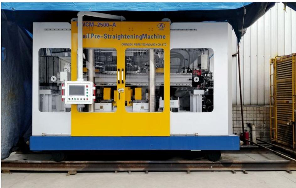
Schienenrichtmaschine »RWCM-2500-A« von Aigre Tech mit dem Multitouch-Einbau-Panel-PC »CP22xx« zur komfortablen Bedienung (Bild: Aigre Tech).
