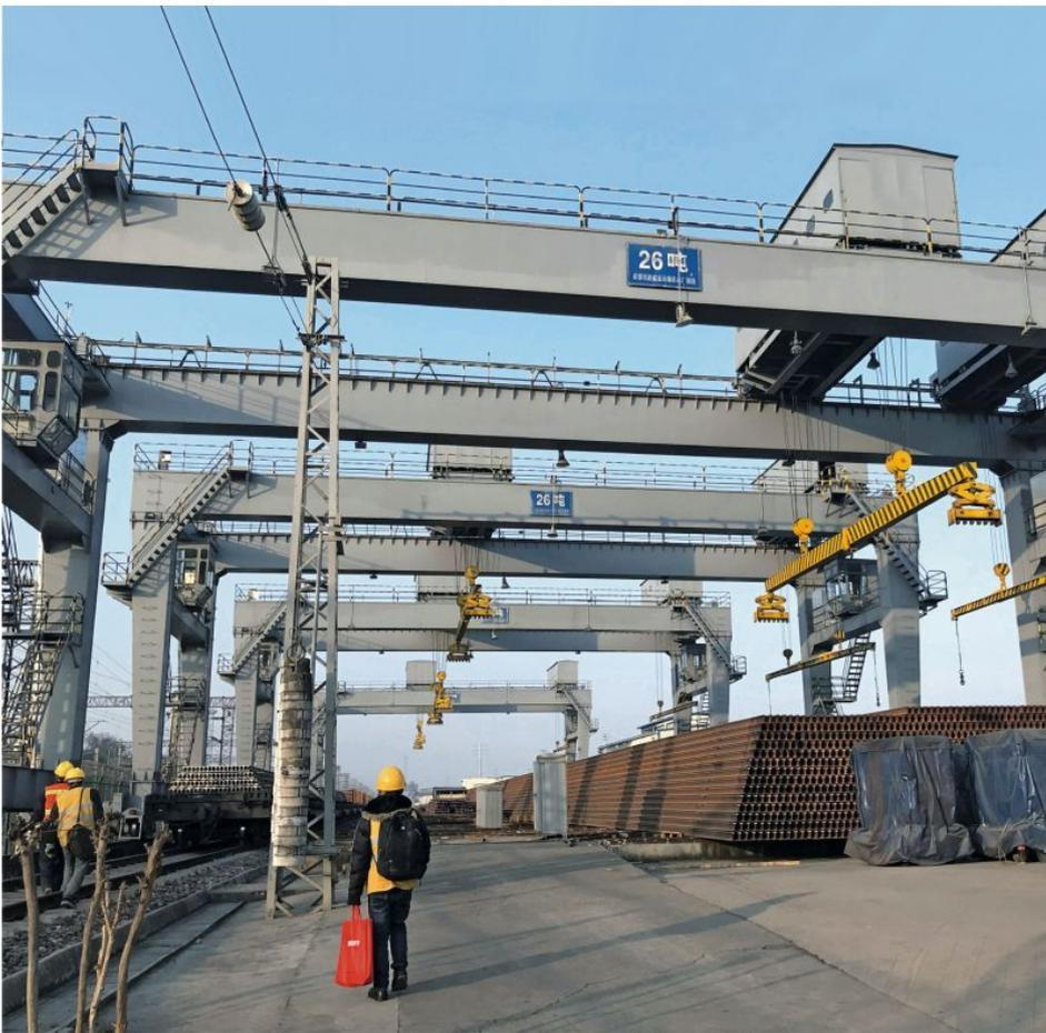
Tandemkran-Hubsystem von China Railway u. a. zur Handhabung von 100 Meter langen Eisenbahnschienen (Bild: China Railway).
