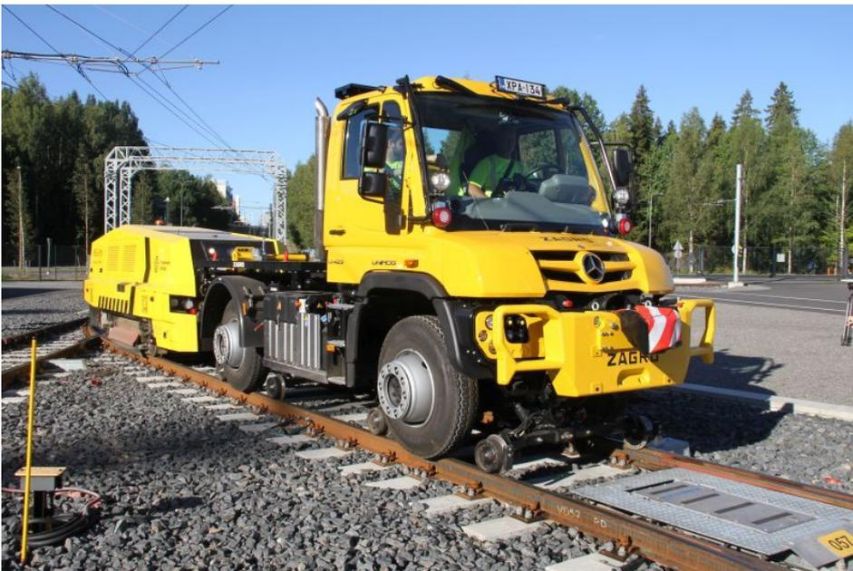
Der »U 430« als Zugmaschine für eine Schienen-schleifmaschine von Vossloh (Bild: Tapani Pa-lo/Konepörssi).
