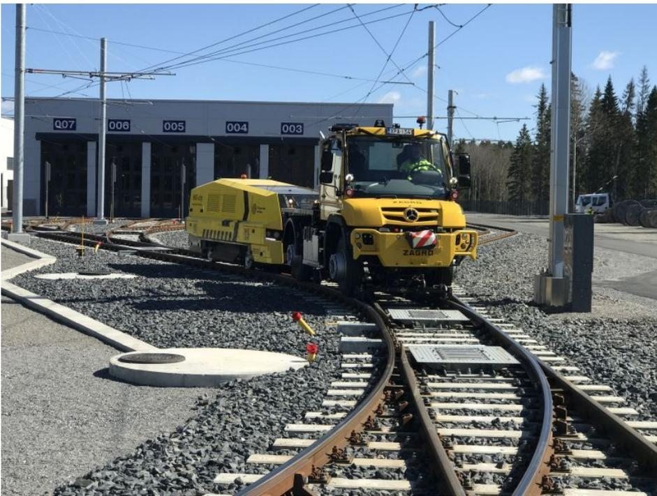
Einmal im Monat wird das komplette Schienennetz von Tampere mit der Schleifmaschine bearbeitet (Bild: Tapani Palo/Konepörssi).
