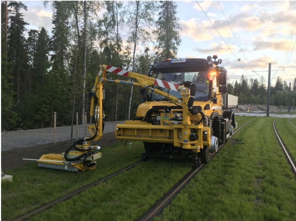
Für die Pflege des Begleitgrüns wird ein Auslegermähergerät frontseitig angebaut (Bild: Daimler Truck AG).
