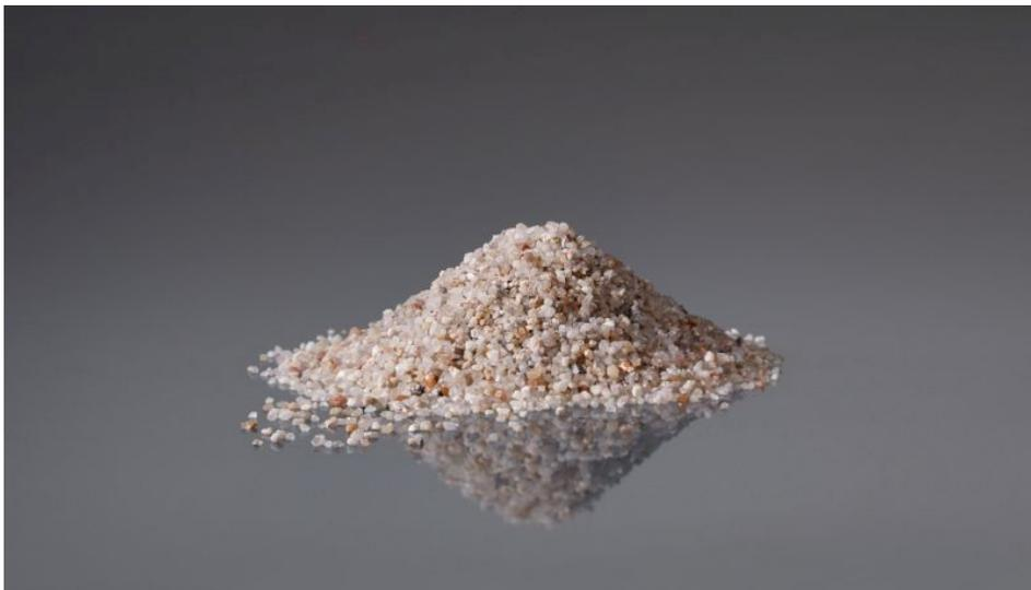
Für mehr Reibung zwischen Gleis und Rad sorgt (Lok-) Bremssand Bild: Wolff & Müller Quarzsande GmbH).
