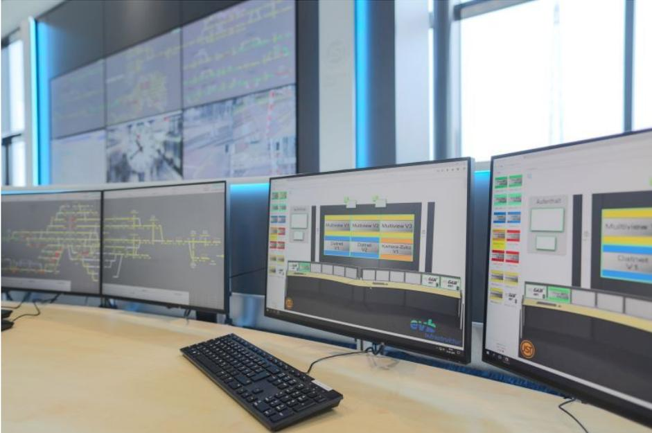
Für ein komfortables und intuitives Handling der verschiedenen Systeme sorgt die sogenannte »myGUI«. In dieser interaktiven 3D-Bedienoberfläche für das MultiConsoling werden alle Konsolen der Arbeitsplätze und die Großbildwand als Kontrollraumbild dargestellt, das heißt als grafisches Modell der Bedienzentrale (Bild: Jungmann Systemtechnik).
