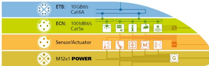
Das aktuelle «rail approved» Produktprogramm von ESCHA umfasst Lösungen, die auf vier unterschiedlichen Verdrahtungsebenen eingesetzt werden können (Bild: ESCHA).
