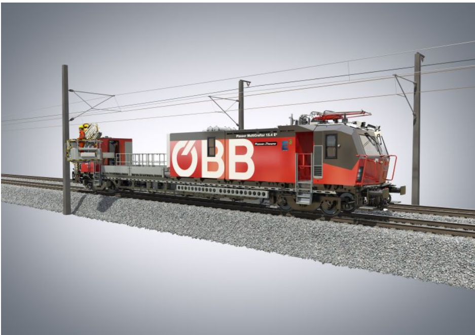
Plasser MultiCrafter 15.4 E³ | Typ 3 ausgestattet mit Ladefläche und Kran für vielseitige Arbeiten am Oberbau.
