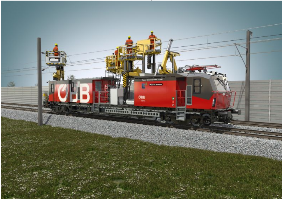
Plasser CatenaryCrafter 15.4 E 3 | Typ 1 mit dreiteiliger Hubarbeitsbühne und Kran optimiert für Montage (Bilder: Plasser & Theurer).
