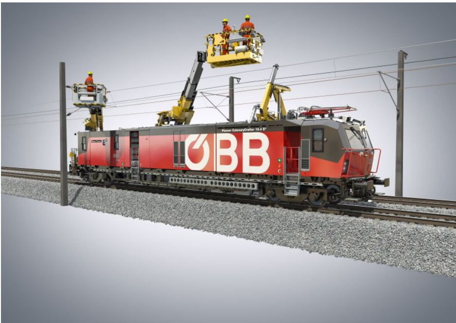
Plasser CatenaryCrafter 15.4 E³ | Typ 2 mit frei verschwenkbarer Arbeitsbühne und Kran optimiert für Inspektion und Wartung.
