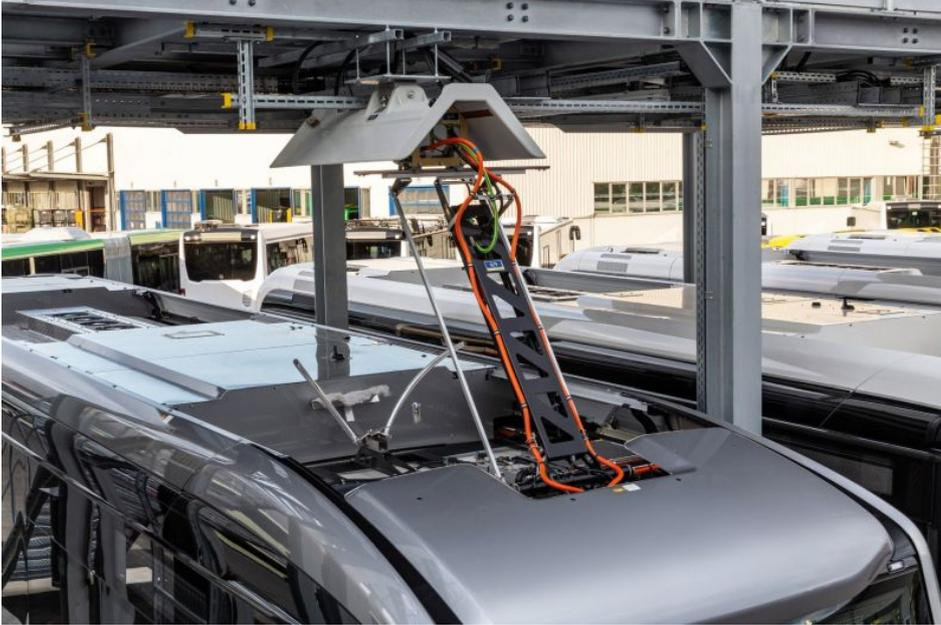
Beispiel für eine zentrale Stromtankstelle wie hier im Omnibuswerk Mannheim für den »eCitaro« (Bild: Daimler Truck).
