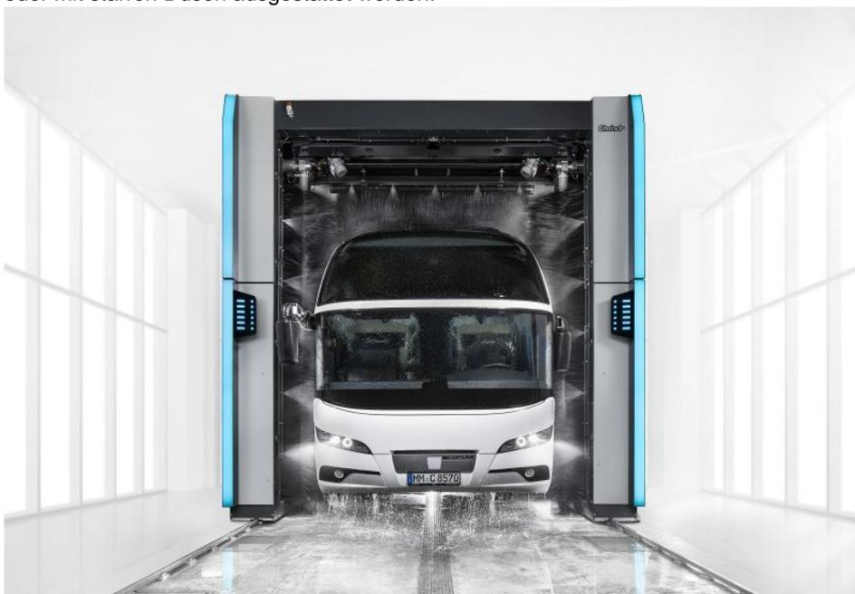
Die »NOVA« bietet noch viele weitere Features und innovative Lösungen wie z. B. die automatische Erkennung von Spiegeln sowie Kamerasystemen. Die Anlage erkennt und umfährt diese automatisch durch intelligente Wirkleistungsmessung. Der Betriebsfluss wird erheblich vereinfacht, da die Seitenspiegel weder abgehängt noch eingeklappt werden müssen. Kamerasysteme werden automatisch umfahren und somit Spiegelschäden vermieden.
