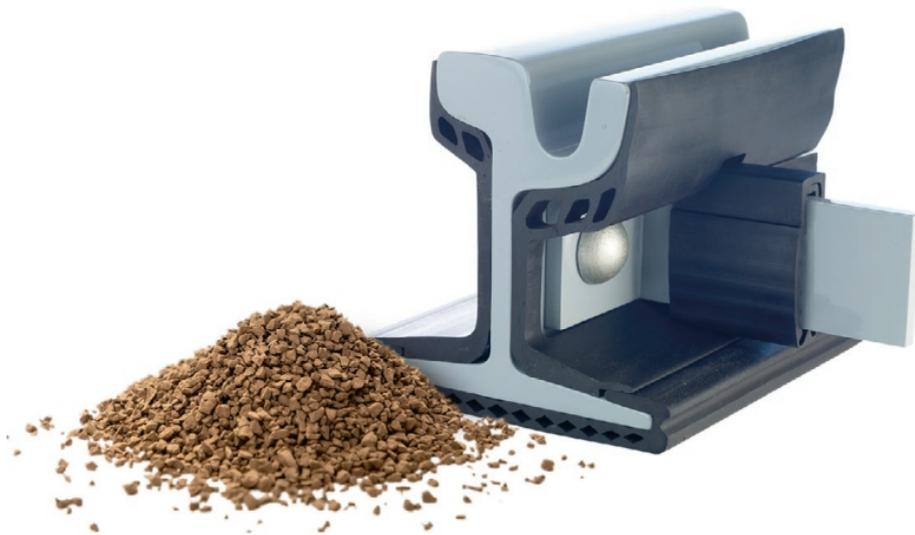
Die Schienenlagerung »RCS greenline« koppelt den Oberbau wirksam von Gleis ab und reduziert somit Erschütterungen. Als Besonderheit wurde der Rußanteil nun teilweise durch einen »funktionalen Füllstoff« aus Holz ersetzt (Bild: Sealable).
