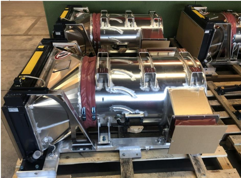
Plug-in Stromrichterkühlanlage schwingungs- und vibrationsentkoppelt anhand von Weichstoffkompensatoren von Frenzelit.
