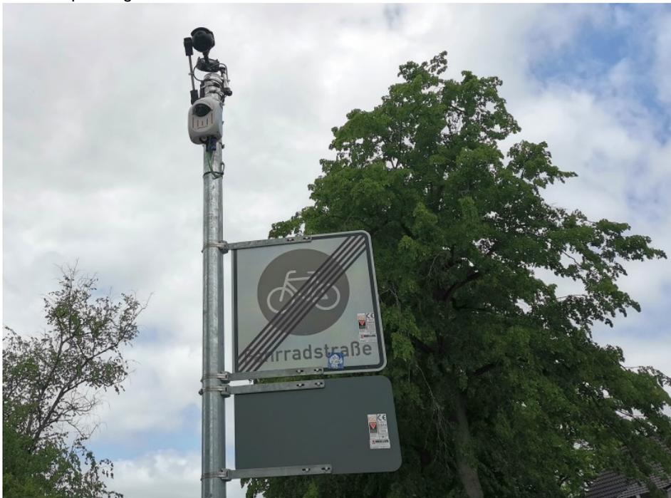
Der »Mobility Analyser« mit Regensensor und richtungsabhängige Fahrraderkennung sorgt für eine intelligente Ampelschaltung (Bild: Bernard Gruppe).
