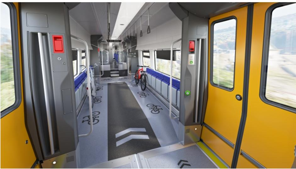
Design des Fahrradabteils für den neuen »Mireo« (Bild: Siemens).
