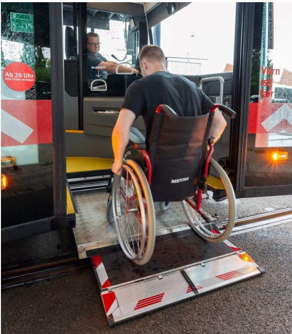
Nach Betätigung der »Rolli-Taste« neben der Tür fährt der Lift automatisch aus. Das Ein- und Aussteigen ist so für alle Rollstuhlfahrer ohne fremde Hilfe möglich (Bilder: Palfinger Tail Lifts).
