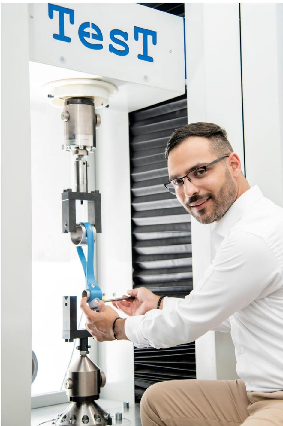
Im Labor werden die Materialien unter anderem ausführlich getestet. Hier an einer Zug- & Druckkraft Prüfmaschine (Bild: faigle).
