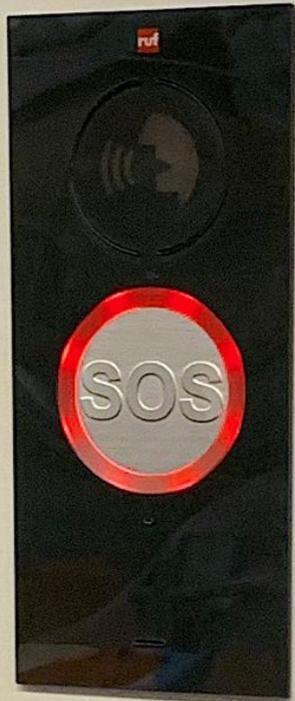
»VisiWeb«-Notsprechsystem in der Türsäulenverkleidung eines Trams der HAVAG. Die schmale Bauform wurde speziell für den Einbau bei beschränkten Platzverhältnissen wie in Trams und U-Bahnen entwickelt (Bild: Ruf Gruppe).
