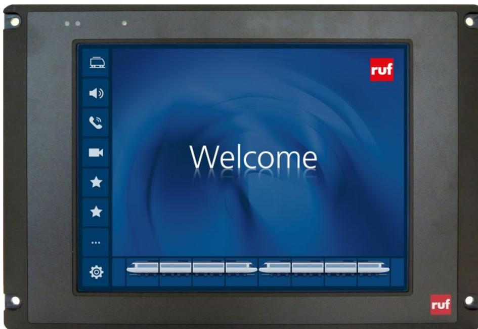
»VisiWeb«-Bedienpanel im Führerstand einer S-Bahn Komposition. Übernimmt die Steuerung und Diagnose aller integrierten Module und zeigt zudem die Kamerabilder der Videoüberwachung an (Bild: Ruf Gruppe).
