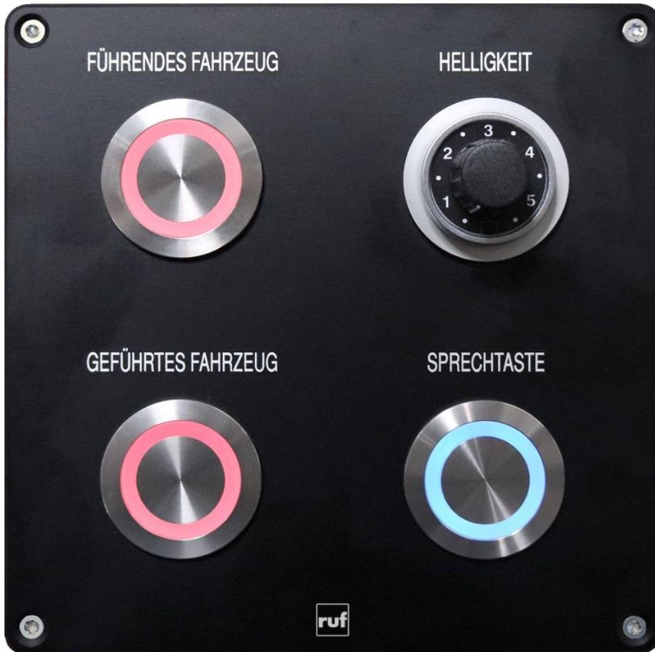
Betreiberspezifische Anforderungen abdeckt: Das Kontrollpanel für das »VisiWeb«-Notsprechsystem im Führerstand des HAVAG-Trams wurde von Ruf kundenspezifisch entwickelt, gefertigt und in die bestehende Infrastruktur integriert (Bild: Ruf Gruppe).
