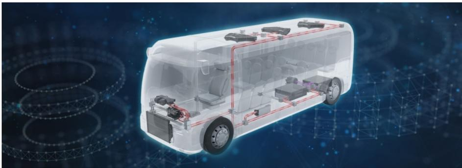
Das Webasto »eTM« ist ein elektrisches Thermomanagementsystem, das sowohl die Traktionsbatterien als auch die Fahrer- und Passagierkabine auf optimaler Temperatur hält (Bild: Webasto).
