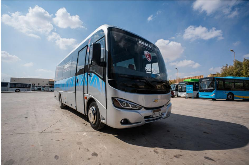
Der Midibus »Nubia« hat 33 Sitzplätze und wird von einem 4 Zylinder-Dieselmotor angetrieben (Bild: Geyushi).
