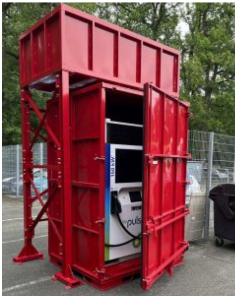
Havariebehälter (Sonderlösung) als Umhausung für eine 150 kW Ladestation mit Löschwasserspeicher (Bild: Paul Müller).
