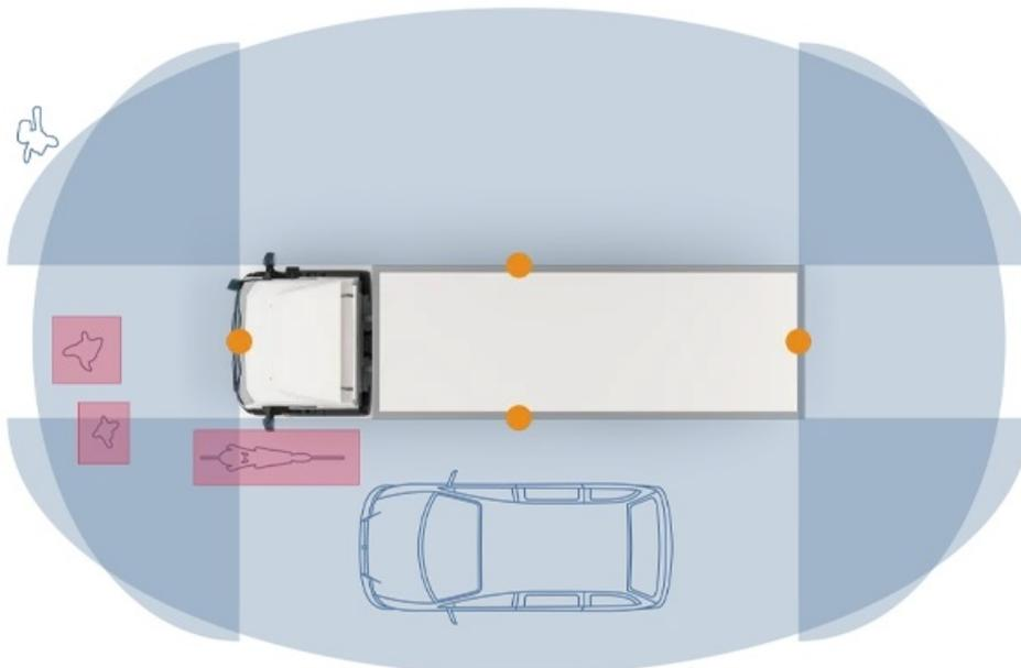
Über die vier Kameraansichten wird nahtlos ein Rundumbild erzeugt (Bild: Brigade).
