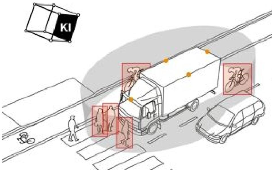
Sämtliche tote Winkel vor, neben und hinter dem Fahrzeug werden sichtbar gemacht und erhöhen die Sicherheit aller Verkehrsteilnehmer (Bild: Brigade).
