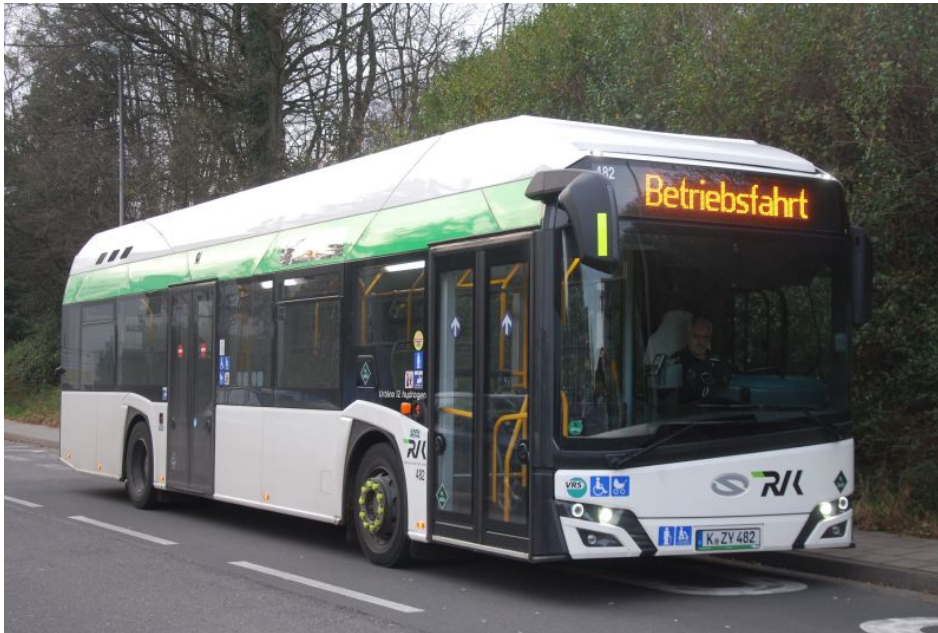
Solaris »Urbino 12 hydrogen«, Wagen 482 der Regionalverkehr Köln mit Antrieb durch Wasserstoff-Brennstoffzelle (Bild: Christian Marquardt).
