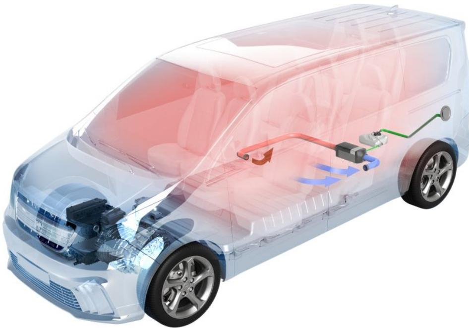
Bei dieser Nachrüstlösung für E-Fahrzeuge wird das Heizgerät zwischen Vorder- und Hinterachse montiert. Im Umluftbetrieb wird die vorgewärmte Luft aus dem Kofferraum energieeffizient genutzt und im Fußraum verteilt (Bild: Webasto).
