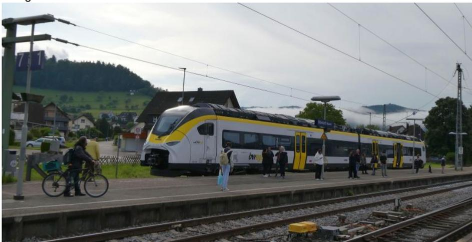
Batteriezug »Mireo Plus B« im Bahnhof Biberach (Schwarzwaldbahn). Der Batteriezug bedient die Nebenbahnstrecke Biberach–Oberharmersbach (nicht elektrifiziert). Die zweiteiligen Triebwagen sind auf jeder Seite mit drei Türen ausgestattet. (Bild: M. Oestreich).
