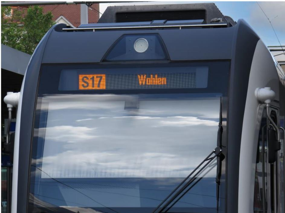
Die neu entwickelte, hochauflösende und energieeffiziente VisiWeb LED-Frontanzeige bietet dank hohem Kontrast auch bei direkter Sonneneinstrahlung perfekte Lesbarkeit
