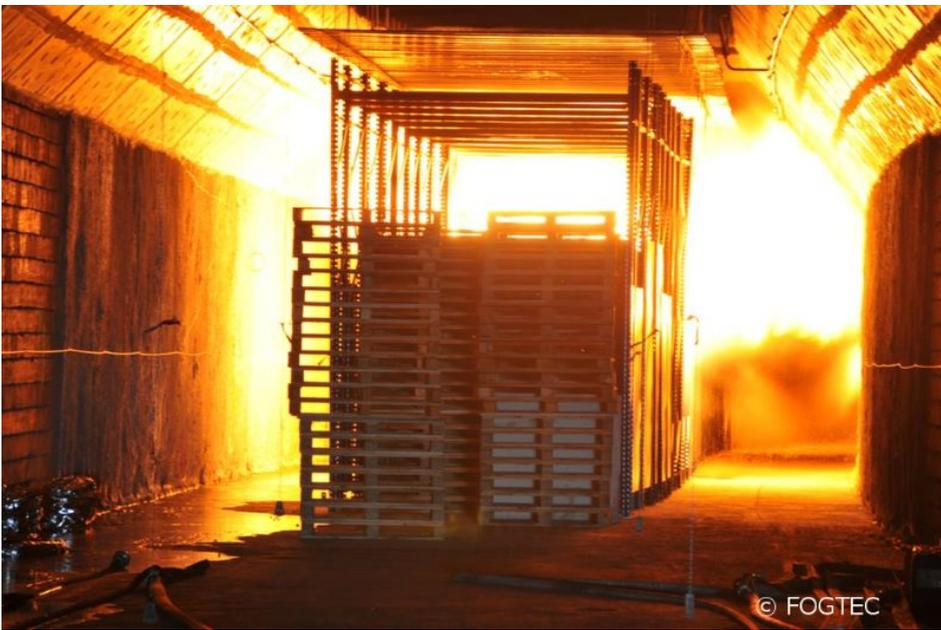
Realbrandversuche im Testtunnel (Bild: Fogtec).
