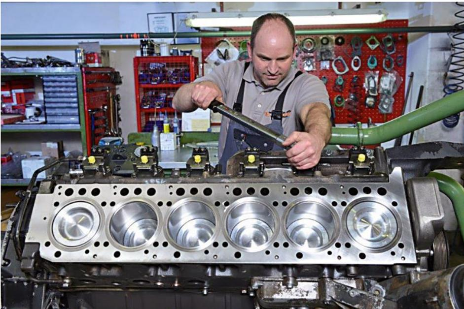
Zu den Kernkompetenzen zählt die Reparatur und die Bearbeitung der Motorblöcke (Bild: Motoren Feuer).
