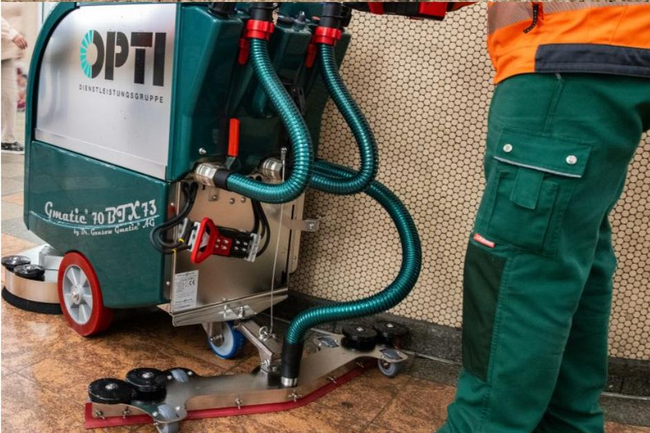
Der Terrazzofußbodenbelag erhält mit der Scheuersaugmaschine »Gmatic 70 BTX 73« eine sanierende Unterhaltsreinigung mit schleifenden Systempads (Bilder: Dr. Gansow).
