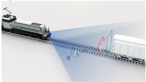
Das System unterstützt auch das Rangierpersonal durch Warnung vor Hindernissen im Gleisbereich wie falsch abgestellten Fahrzeugen oder einer drohenden Kollision bei falsch eingestellten Weichen. Zudem ist eine Kuppelassistenzfunktion und eine Signalerkennung integriert (Bild: Bosch).
