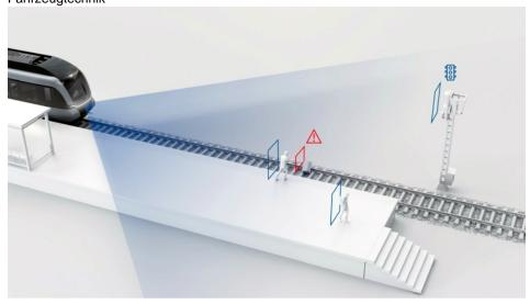
Mehr Sicherheit im Schienenverkehr – das Kollisionswarnsystem »Rail Forward Assist« ermöglicht eine nahtlose Überwachung des Bereichs vor dem Triebfahrzeug (Bild: Bosch).
