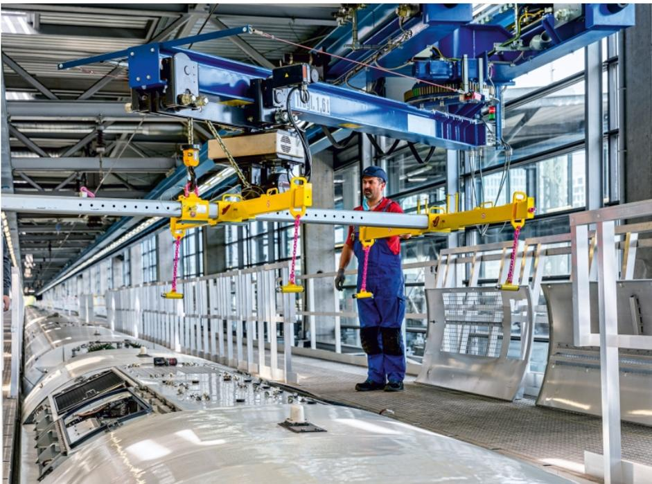
Erstmals vorgestellt werden der neue Steck-Anschlagpunkt »PIP-RAPIDO« und der klickbare Schäkel »CCS-FASTLOX«, welche durch neuartige Funktionsprinzipien das Anschlagen von Lasten deutlich vereinfachen und beschleunigen (Bild: RUD).
