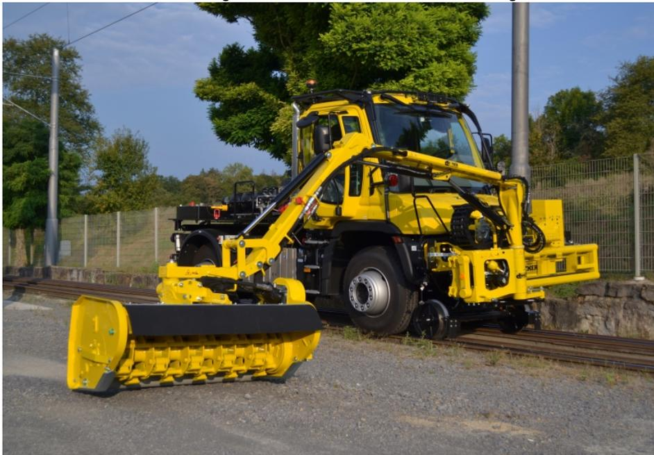
Zagro stattet Unimog »U 423« für Rangieraufgaben und Gleisinstandhaltung aus. Hier mit einem Dücker-Frontmähergerät »UNA 500«.
