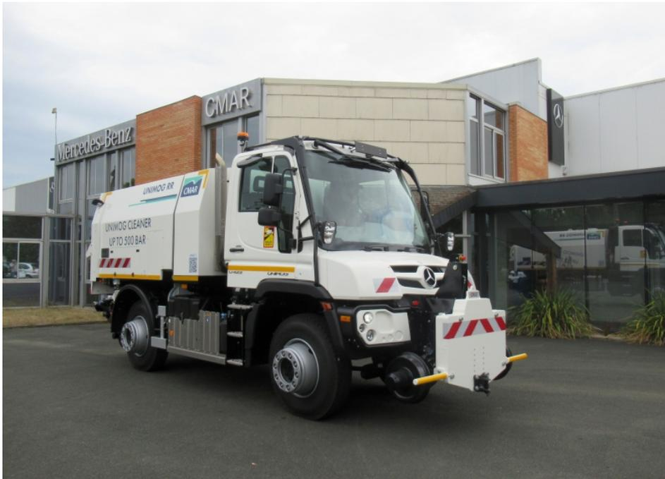
CMAR rüstet Unimog »U 423« für Schienen- und Rillenreinigung im urbanen Schienennetz.
