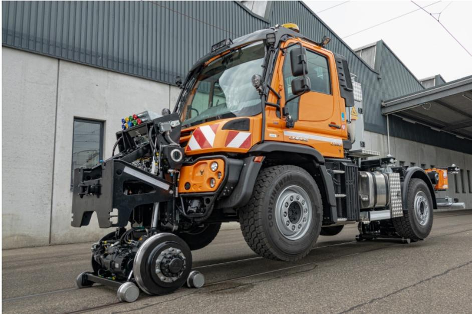
Unimog »U 530« als multifunktionale Arbeitsmaschine mit hydrostatischem Fahrtrieb für Instandhaltungs- und Pflegearbeiten bei Verkehrsbetriebe Zürich (VBZ).
