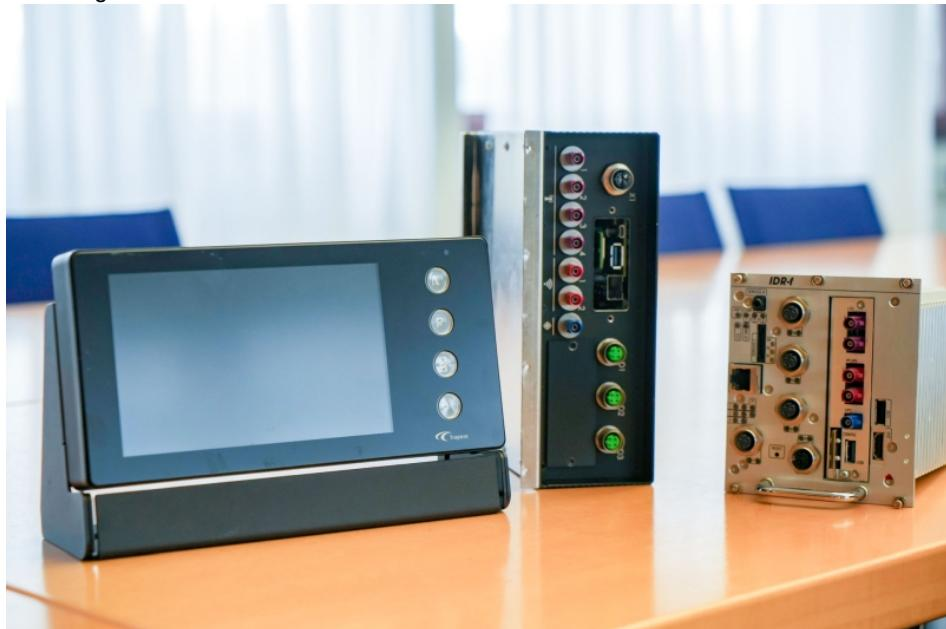
Trapeze-Produkte für die Fahrzeugausrüstung: Bedienterminal für den Fahrer, Fahrzeug-Router und Bordrechner (Bild: SSB).
