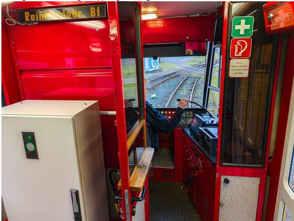
Blick in den Fahrgastraum eines »KT4D«-Trams. Links im Bild die betriebsbereite »VisiWeb«- Notsprechstelle (Bild: Ruf Gruppe).
