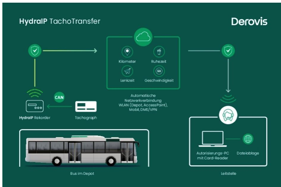
Mit »TachoTransfer« vereinfacht Derovis das Datenhandling durchgreifend (Bild: Derovis).
