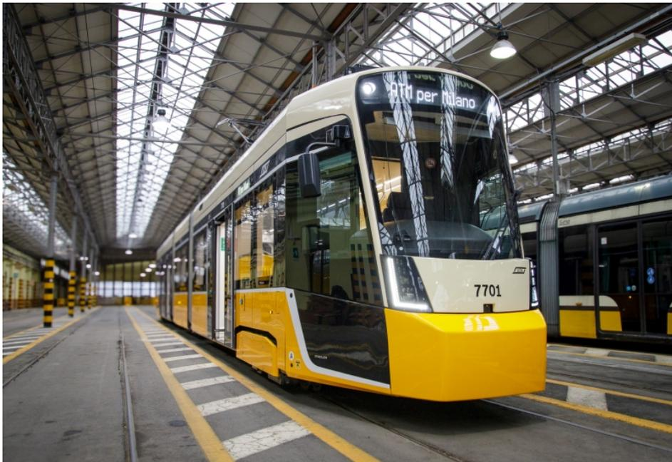
Die neuen Trams vom Typ »TRAMLINK« sind 25 m lang und bestehen aus drei Modulen (Bild: Stadler).
