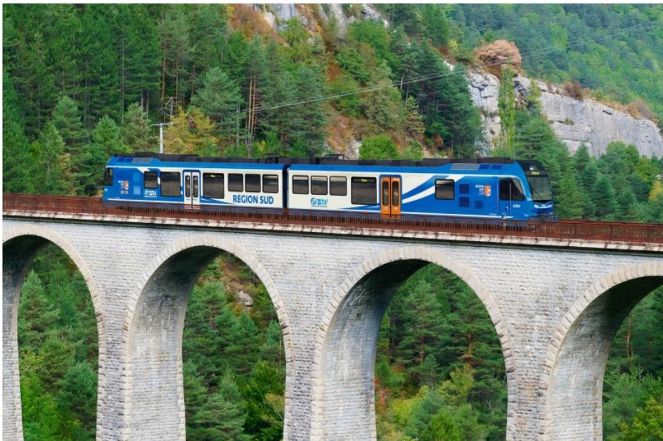
Die Höhenunterschiede bewältigen die »BEMU«-Meterspur-Triebzüge mit Batterie und Biodiesel (Bild: Stadler).
