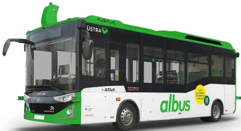
Der »Autonomous eATAK« ist der erster zugelassene Level-4-Bus im deutschen Straßenverkehr, im Einsatz auf der Linie 906 in Hannover (Bild: Karsan).
