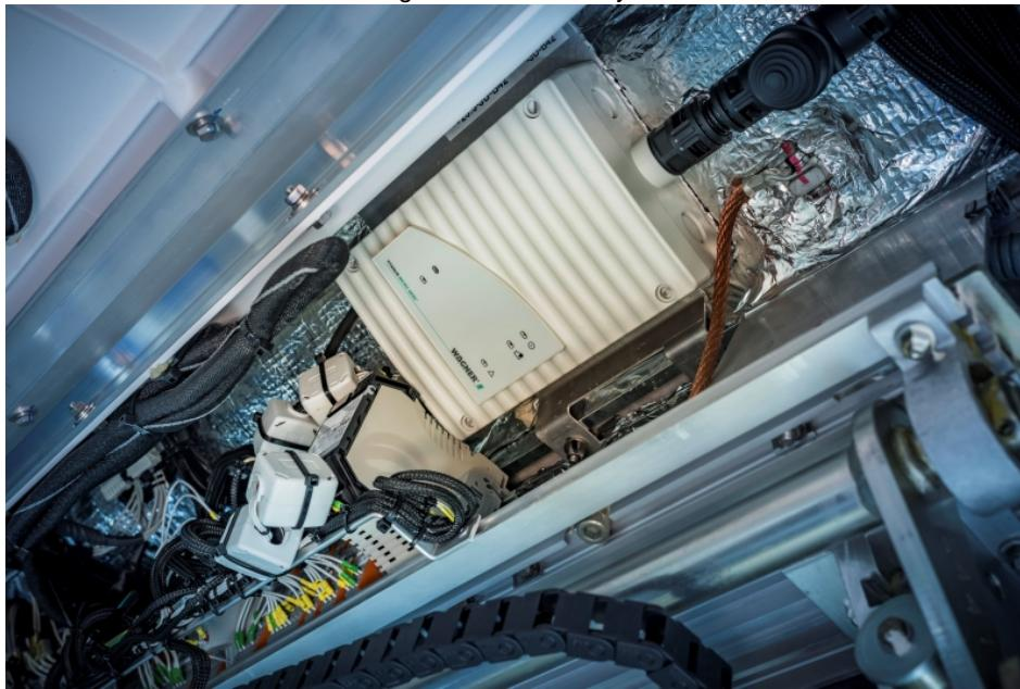
Die Detektionsgeräte der »Titanus« Ansaugrauchmelder-Systeme sind in Zügen unauffällig unter Verkleidungen montiert und somit nicht anfällig für Vandalismus (Bild: Wagner Group).
