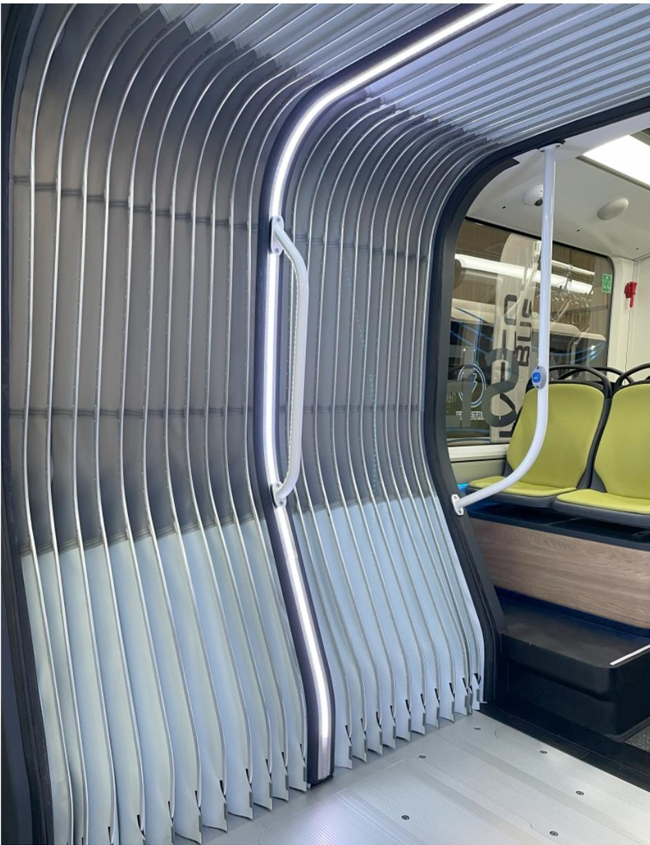
Die neue LED-Beleuchtung sorgt für mehr Sicherheit und eine höhere Aufenthaltsatmosphäre im Übergangsbereich (Bild: Hübner).
