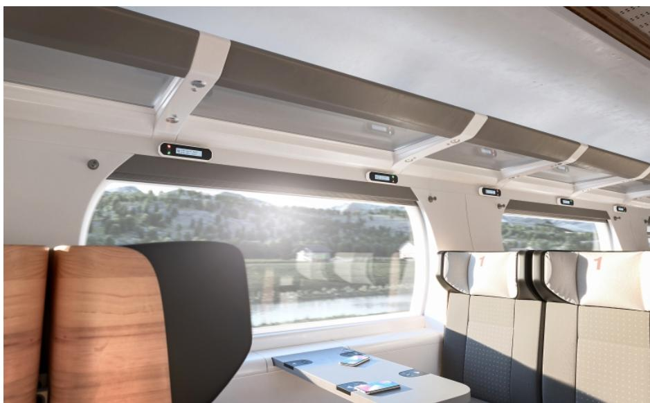
Das neue Sitzplatzreservierungssystem integriert sich harmonisch in moderne Zugabteile und macht dank leuchtstarker LED-Anzeigen Sitzplatzstatus und Verfügbarkeiten auf einen Blick sichtbar (Bild: EAO).
