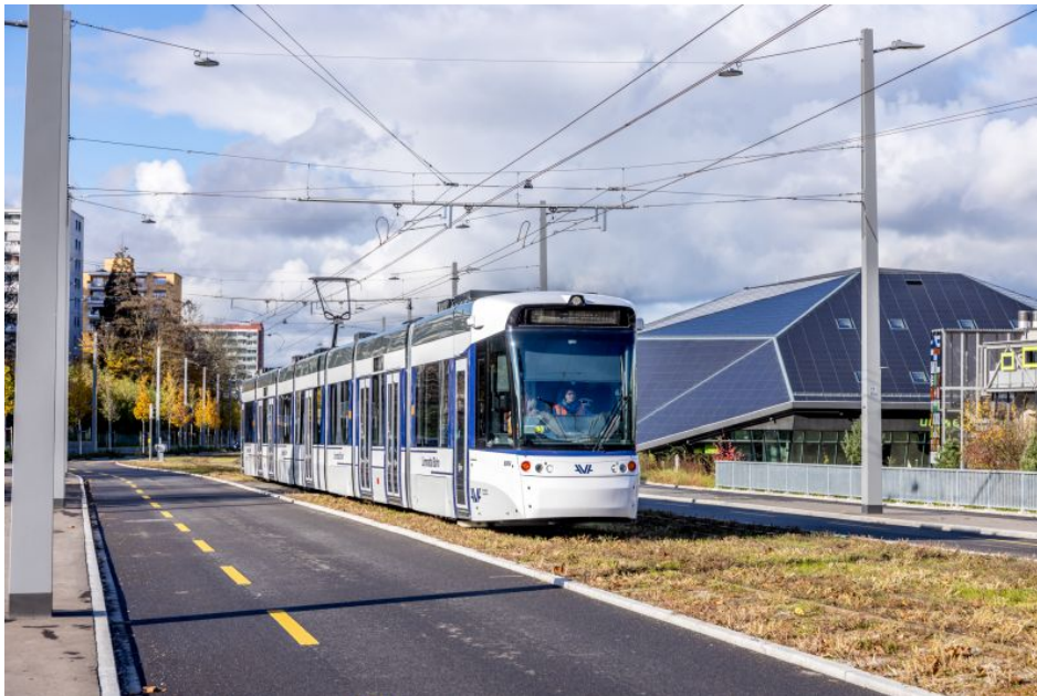
Limmattalbahn (LTB): Tramfahrleitung mit doppelter Feederleitung (Bild: Furrer+Frey)
