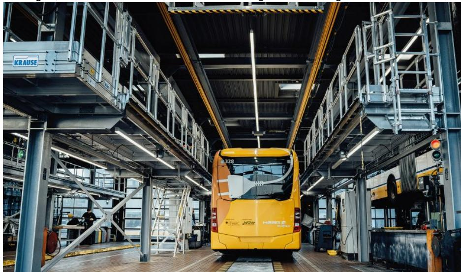
Die Dacharbeitsstände erhöhen die Arbeitssicherheit, verbessern die Wartungseffizienz und passen sich flexibel an unterschiedliche Einsatzszenarien an.
