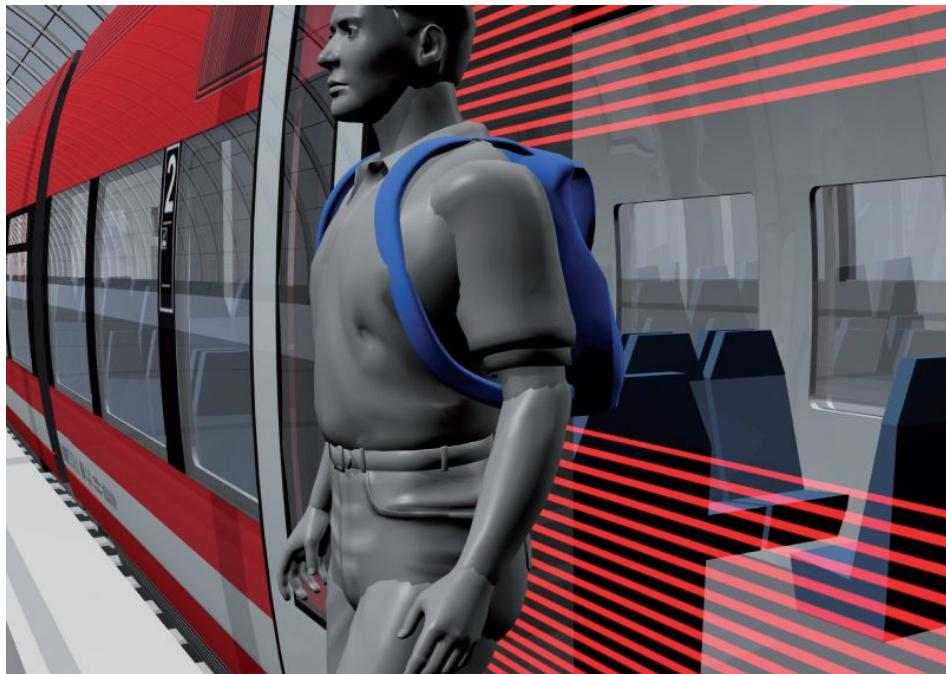
Unsichtbare Sicherheit: »SITRANS alpha S1-Rail« erkennt mit infrarotbasierter Rastertechnologie selbst kleinste Objekte im Türbereich. Die Unterbrechung eines einzelnen Lichtstrahls reicht aus, um das Schließen der Tür zu verhindern (Bilder: Sitron Sensor).
